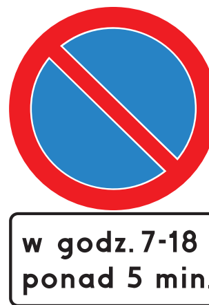
Rys. 3.2.36.12. Znak z informacją na tabliczce o okresie obowiązywania zakazu i czasie postoju
