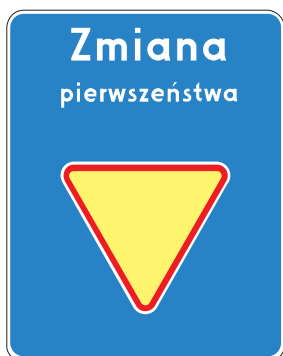
Rys. 5.2.54.2. Znak D-48 wskazujący wlot podporządkowany
