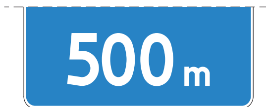
Rys. 5.1.1.3. Rozmieszczenie na znaku napisu podającego odległość
