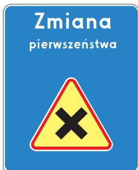
Rys. 5.2.54.1. Znak D-48 wskazujący skrzyżowanie dróg równorzędnych
